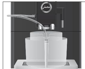
**i** Um den Milchschauch korrekt mit dem Behälter verbinden zu können, muss der Milchschauch mit einem Anschlussstück ausgestattet sein.
