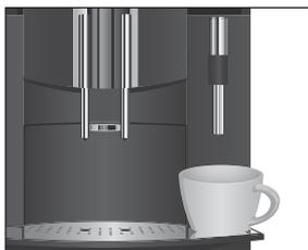
**i** Monte o bocal de água quente no Connector System® para a preparação de água quente.
